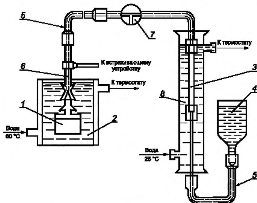
1 — реакционный сосуд; 2 — термостат; 3 — измерительная бюретка; 4 — уравнительный сосуд с подкрашенной водой;
