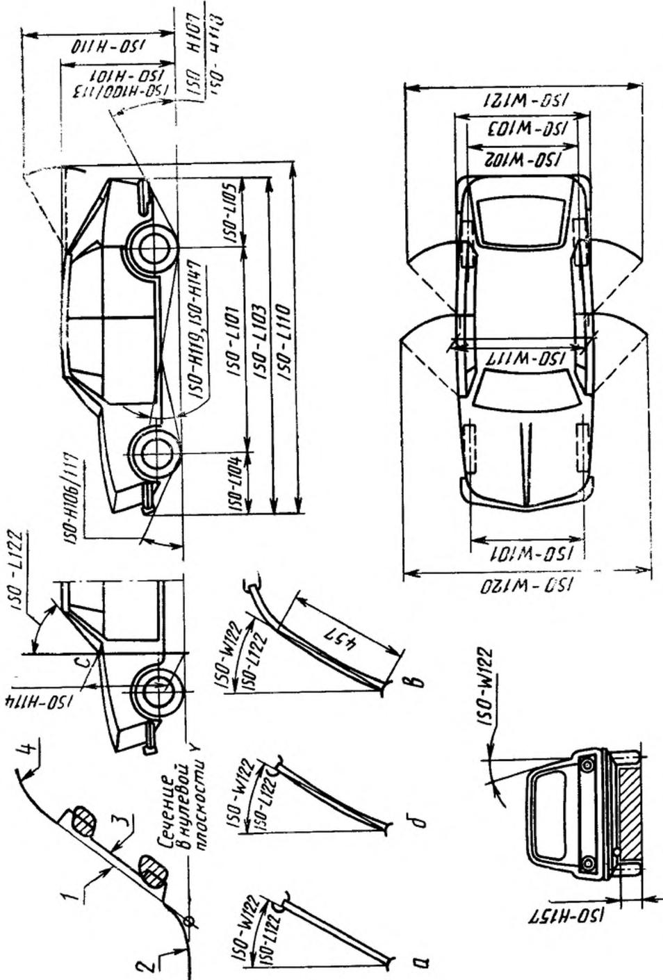
1 — условная чертежная линия; 2 — капот; 3 — ветровое стекло; 4 — поверхность крыши;
