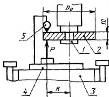
$D_0$  — диаметр опорного диска;  $R$  — радиус нагружения
