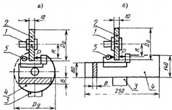
$D_g$  — диаметр приспособления для крепления нагружающего устройства;  $B$  — ширина приспособления для крепления нагружающего устройства;  $D_n$  — диаметр опорного диска;  $R$  — радиус нагружения
