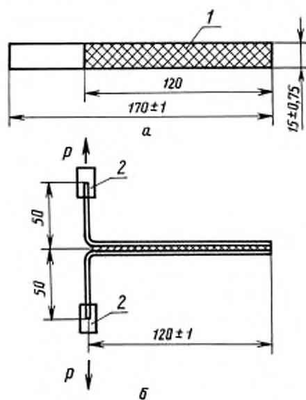
*a* – подложка; *б* – образец для испытания, 1 – площадь склеивания; 2 – захват
