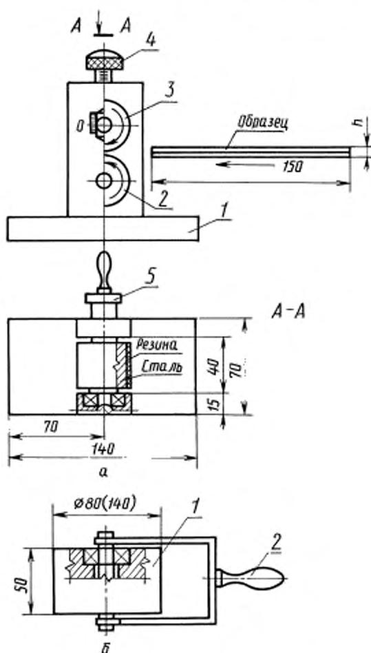
*a* — механическое приспособление: 1 — основание; 2 — ведущий валок диаметром 40 мм; 3 — ведомый валок диаметром 40 мм; 4 — регулировочный винт; 5 — рукоятка (привод); *б* — ручное приспособление: 1 — каток; 2 — ручка
