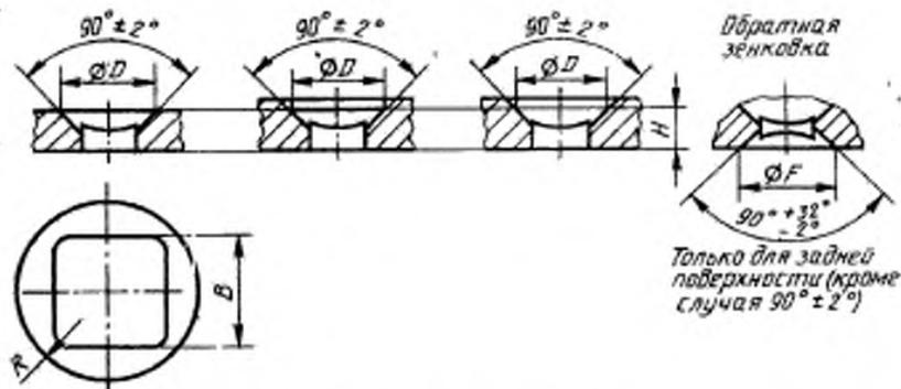
$D$  — диаметр зенковки для эффективной толщины  $H$ ;  $B$  — ширина между гранями квадратного отверстия;  $H$  — минимальная эффективная толщина;  $R$  — радиус закругления квадратного отверстия;  $F$  — диаметр обратной зенковки квадратного отверстия
