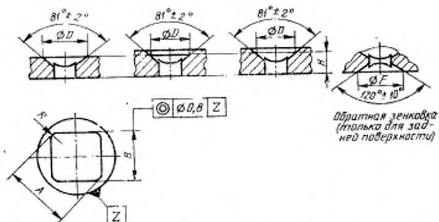
$D$  — диаметр обратной зенковки для эффективной толщины  $H$ ;  $B$  — ширина между углами квадратного отверстия;  $H$  — минимальная эффективная толщина;  $R$  — радиус закругления квадратного отверстия;  $A$  — размер по диагонали квадратного отверстия;  $F$  — диаметр обратной зенковки квадратного отверстия
