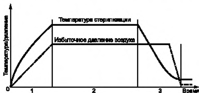
Рисунок В.3 — Пример цикла стерилизации паровоздушной смесью
