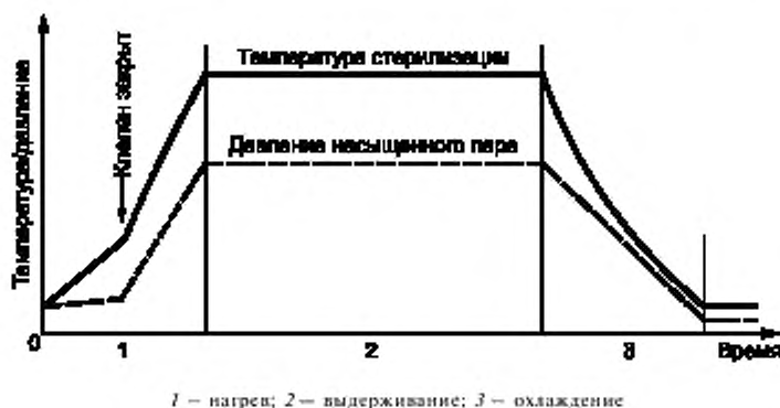
Рисунок V.1 — Пример цикла стерилизации с использованием насыщенного пара и проветривания
