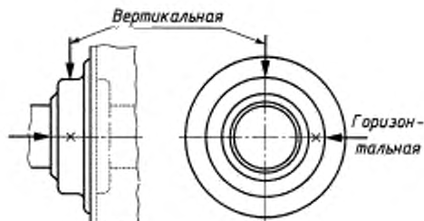
Рисунок 1б — Точки измерения на корпусе подшипника
