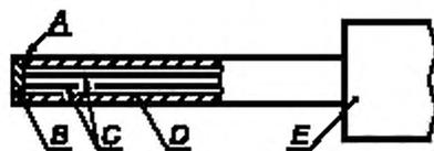
A — клеевое соединение; B — облуженный медный диск диаметром 5 мм, толщиной 0,5 мм; C — термопарные провода диаметром 0,3 мм (тип ХА (К) по ГОСТ Р 8.585); D — трубка из поликарбоната внутренним диаметром 3 мм и внешним диаметром 5 мм; E — ручка для создания контактного усилия (4 ± 1) Н
