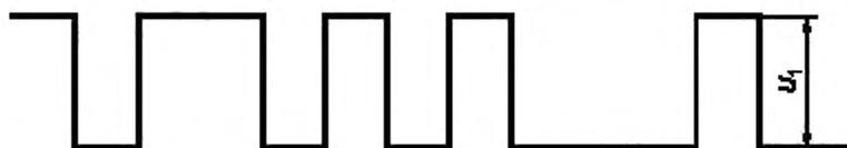
Рисунок 2 — Диаграмма, поясняющая измерение размаха сигнала
