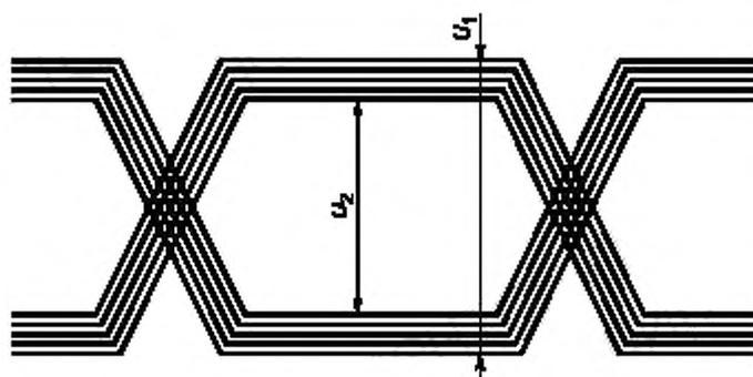
Рисунок 7 — Диаграмма, поясняющая измерение дрожания уровня цифрового сигнала
