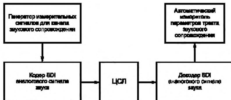
Рисунок 12 — Схема измерения параметров канала звукового сопровождения
