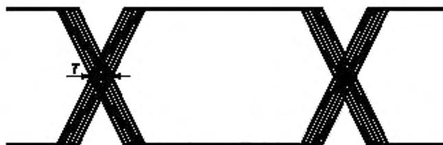
Рисунок 8 — Диаграмма, поясняющая измерение фазового дрожания цифрового сигнала
