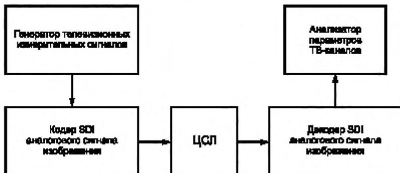
Рисунок 11 — Схема измерения параметров канала изображения
