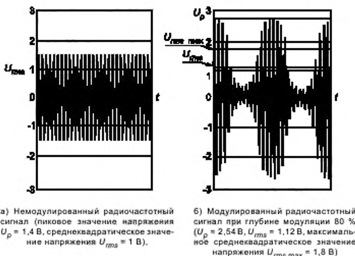
Рисунок 1 — Определение степени жесткости испытаний и формы колебаний на выходе генератора сигналов
