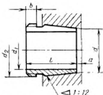
3. Втулки должны изготавливаться из стали с пределом прочности на растяжение не менее 400 Н/мм<sup>2</sup>.
