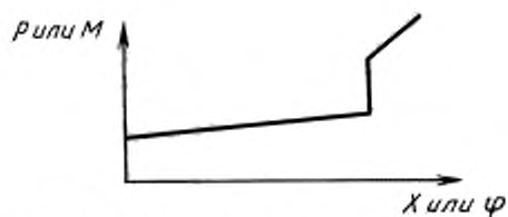
P, M — упругая сила или момент силы, действующие на узел изделия; \chi, \varphi — перемещение или угол поворота узла изделия
