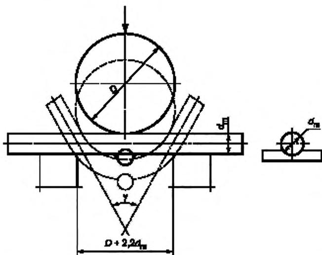
$d_n$  — максимальный размер поперечного сечения испытываемого арматурного проката
