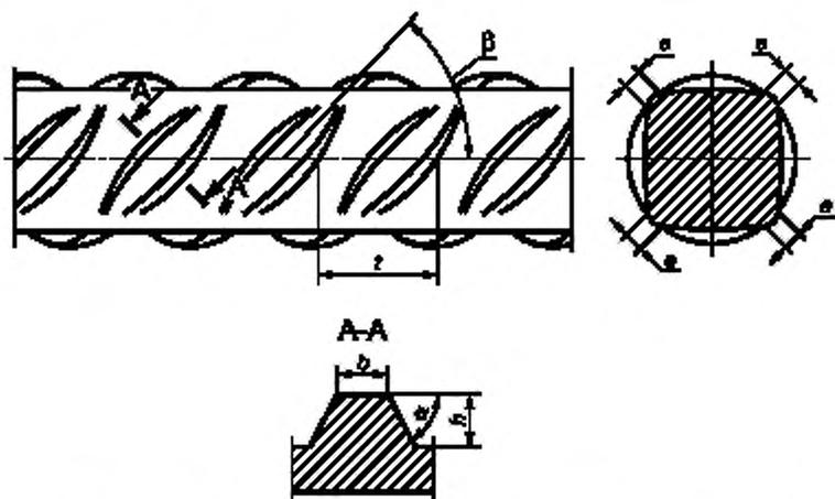
Рисунок А.3 — Четырехсторонний сегментный периодический профиль холоддеформированного арматурного проката
