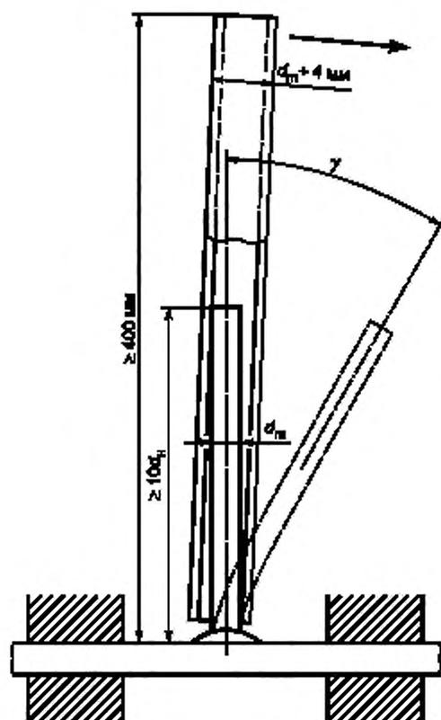
$d_n$  — максимальный размер поперечного сечения испытуемого арматурного проката
