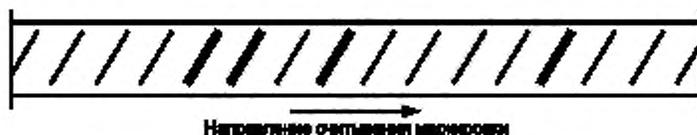
Рисунок 2 — Пример прокатной маркировки предприятия-изготовителя под номером 14
