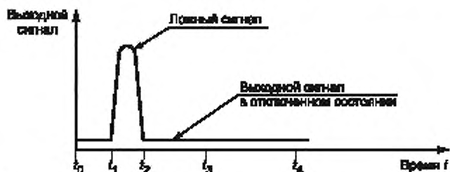
Рисунок 7б — Коммутационный элемент в выключенном состоянии
