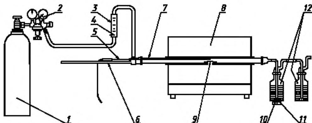
1 – баллон с искусственным воздухом; 2 – редуктор; 3 – ротаметр; 4 – игольчатый вентиль; 5 – термопара;
