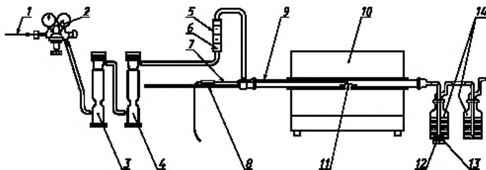
1 – сжатый воздух; 2 – редуктор; 3 – воздушный фильтр (активированный уголь); 4 – осушитель воздуха (селикатель);
