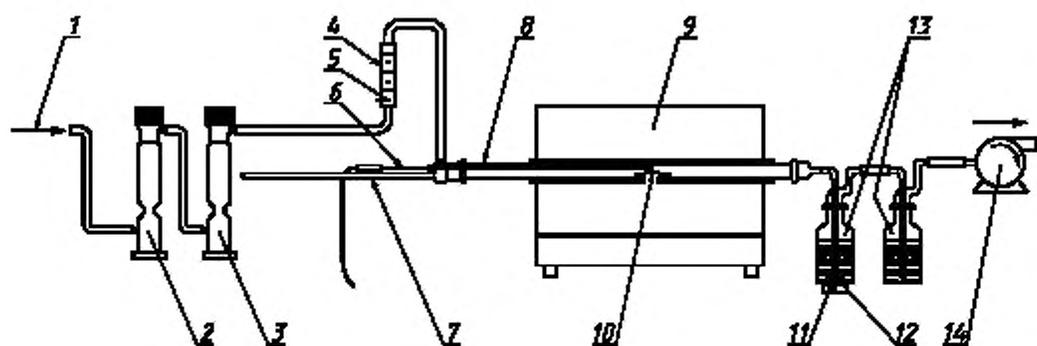
1 – воздух окружающей среды; 2 – воздушный фильтр (активированный уголь); 3 – осушитель воздуха (селикатель),
