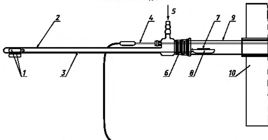
1 – стержневые магниты; 2 – стеклянная трубка; 3 – платиновая проволока; 4 – термопара; 5 – искусственный или сжатый воздух, отфильтрованный и осушенный; 6 – стандартное притертое соединение, размер которого соответствует диаметру трубки из кварцевого стекла; 7 – образец; 8 – лодочка; 9 – трубка из кварцевого стекла; 10 – печь
