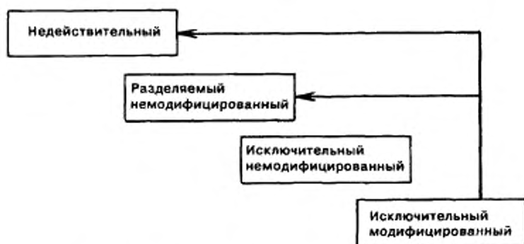
Рисунок 8—5 — Состояние «исключительный модифицированный»
