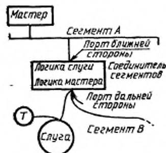
Рис. 21. Понятия ближней и дальней стороны для СС мог бы использоваться другой тип СС. Но два СС последнего типа не эквивалентны первому типу СС из-за различий в способе, с помощью которого должны разрешаться конфликты в использовании соединителя.
