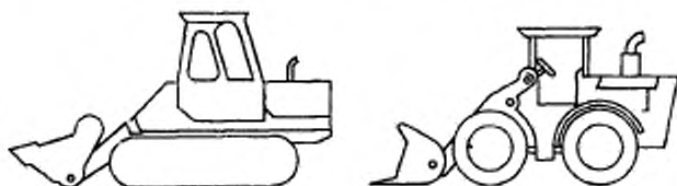
Черт. 4. С задним расположением двигателя
