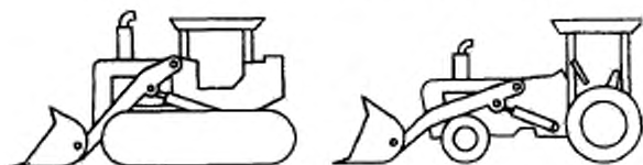
Черт. 3. С передним расположением двигателя
