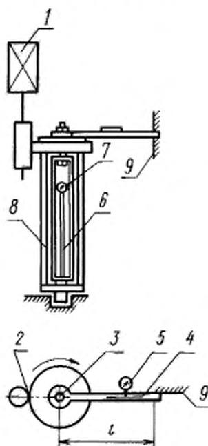
1 — электромотор; 2 — редуктор; 3 — проверяемый болт; 4 — динамометрический ключ; 5 — индикатор динамометрического ключа; 6 — динамометр для измерения усилия натяжения болта; 7 — индикатор динамометра; 8 — корпус прибора; 9 — упор ключа
