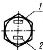
1 — клеймо предприятия-изготовителя; временное сопротивление болта, МПа, деленное на 10; знак исполнения «ХЛ», 2 — условное обозначение номера плавки
