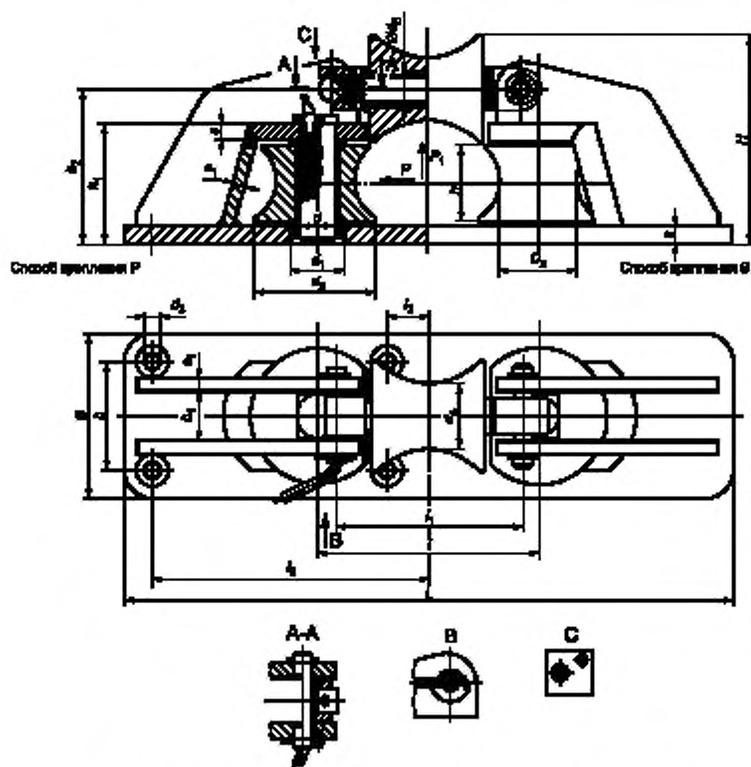
Рисунок 2 — Киявовая планка с откидным роульсом (тип R)
