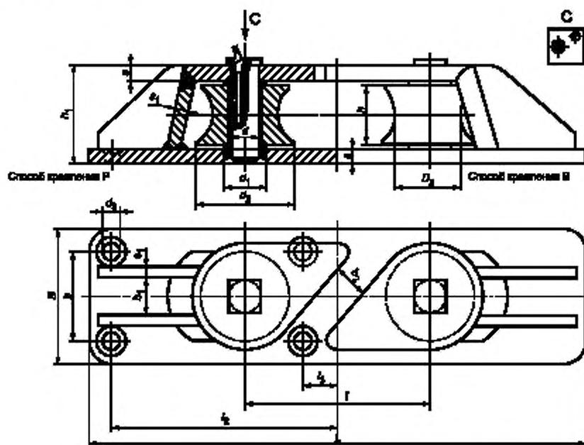
Рисунок 1 — Обычная киявовая планка с роульсами (тип Z)
