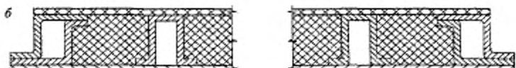
Полотно с наружным стальным листом и внутренним листом из ДВП, с профилями сложного сечения и заполнением из древесного или минерального утеплителя
