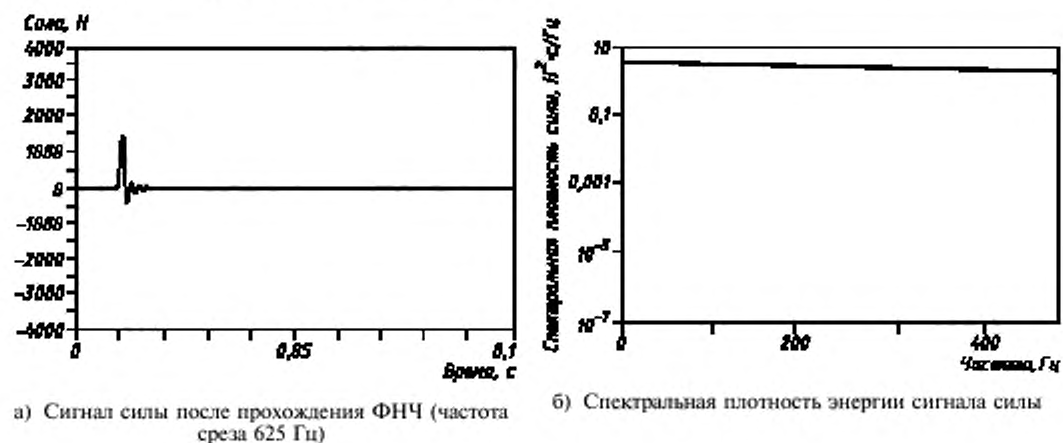
Рисунок 4 — Влияние низкочастотной фильтрации на сигнал силы и его спектр
