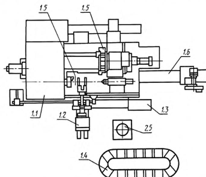
1.1 — токарный или токарно-многоцелевой полуавтомат или станок с ЧПУ, 1.2 — промышленный робот, 1.3 — система управления ГПМ, 1.4 — накопитель заготовок и изделий, 1.5 — устройство измерения деталей на станке и устройство автоматической привязки инструмента, 1.6 — устройство удаления отходов, 2.5 — устройство для кантования изделия
