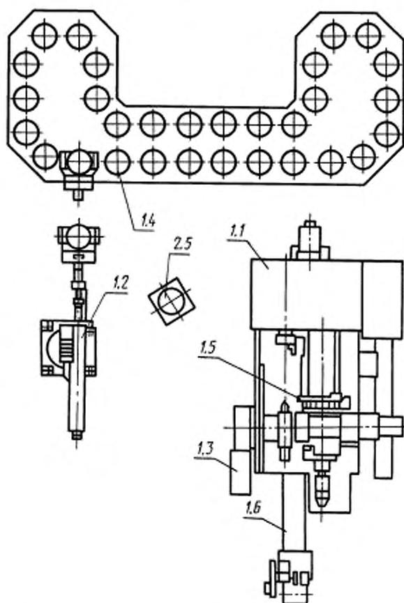
1.1 — токарный или токарно-многоцелевой полуавтомат или станок с ЧПУ, 1.2 — промышленный робот, 1.3 — система управления ГПМ, 1.4 — накопитель заготовок и изделий, 1.5 — устройство измерения деталей на станке, 1.6 — устройство удаления отходов, 2.5 — устройство для кантования изделия
