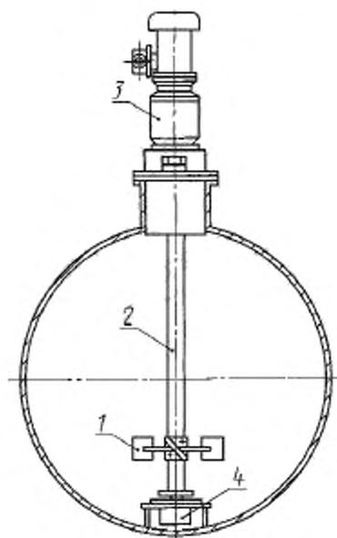
1 — мешалка, 2 — вал; 3 — мотор-редуктор;
