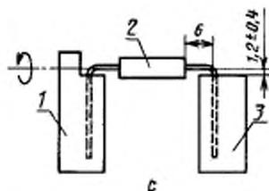
1 — зажим, поворачивающийся на 180°; 2 — испытуемое изделие; 3 — неподвижный зажим
