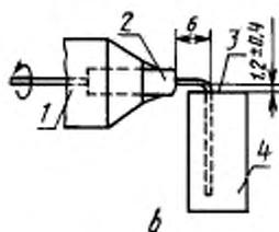
1 — зажим, поворачивающийся на 360°; 2 — испытуемое изделие; 3 — зазор; 4 — неподвижный зажим
