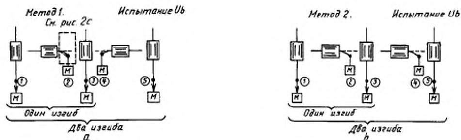
Схема, показывающая угол смещения для гибких выводов
