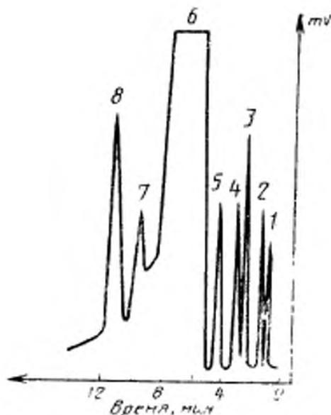
1—метанол; 2—ацетон+метилацетат; 3—винилацетат («внутренний эталон»); 4—метилметакрилат; 5—метилэтилобутират; 6—метилметакрилат; 7—этилметакрилат; 8—диэтил-α-оксиметилбутират
