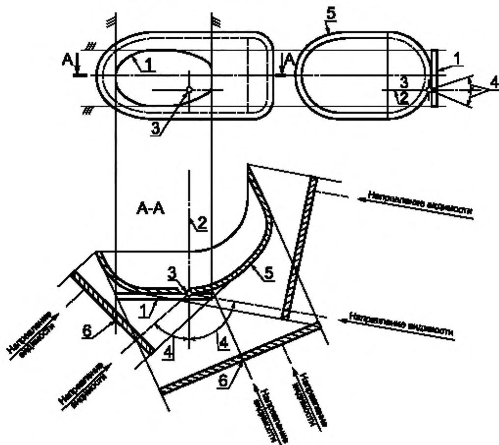
1 — освещающая поверхность; 2 — исходная ось; 3 — исходный центр; 4 — угол геометрической видимости;
