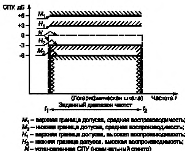
Рисунок Г.2 — Границы допусков в управляющей точке для высокой и средней воспроизводимости
