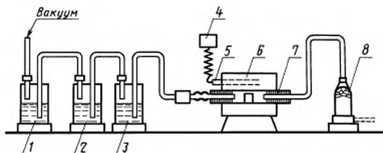
1—3 — склянки Дроксиля поглотительные; 4 — терморегулятор; 5 — термопара; 6 — печь трубчатая, электрическая, типа J СУОЛ 0,25.2,5/14К; 7 — лодочки фарфоровые; 8 — склянка Тищенко СПТ, в нижней части — безводный хлористый кальций, в верхней — кусочки гидроокиси натрия
