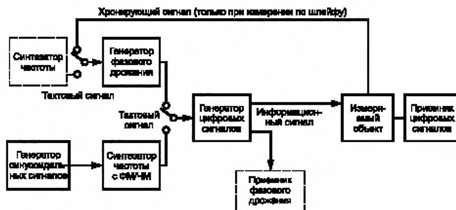
Рисунок 4.9 — Схема измерения допустимого фазового дрожания (метод по критерию появления ошибок)
