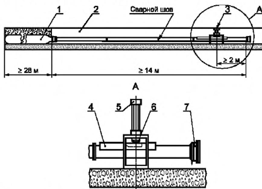
1 — стальной ресивер; 2 — канал; 3 — приспособление для иницирования трещины; 4 — рама для охлаждения; 5 — пневматический цилиндр; 6 — лезвие; 7 — заглушка
