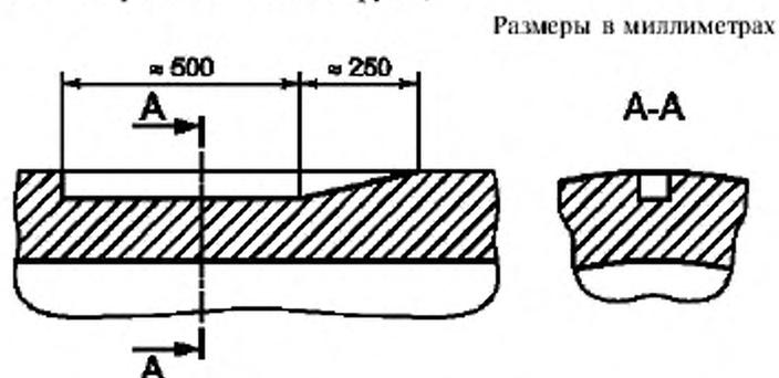
Рисунок 6 — Канавка, обрабатываемая на наружной поверхности трубы
