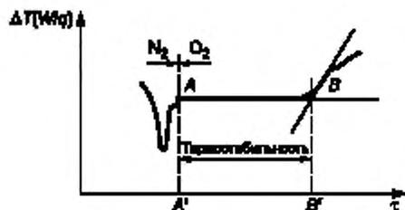
Рисунок 1 — Типичная кривая окислительной термостабильности полиэтилена
