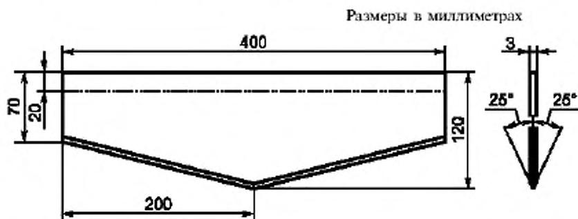
Рисунок 7 — Стальное лезвие для инициирования трещины в полиэтиленовой трубе
