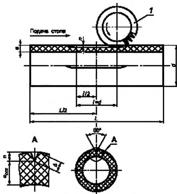
$d$  – наружный диаметр трубы;  $e$  – толщина стенки трубы;  $e_{ост}$  – остаточная толщина стенки трубы;  $l$  – длина надреза;  $L$  – свободная длина образца по ГОСТ 24157;  $b$  – ширина надреза;  $n$  – глубина надреза;  $A$  – двусторонняя фреза с зубьями под углом  $60^\circ$
