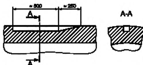
Рисунок 6 — Канавка, обрабатываемая на наружной поверхности трубы
