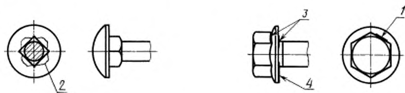
1 — складки; 2 — складки в зоне квадратных подголовков; 3 — складки на радиусе под головкой; 4 — складки на наружных кромках
