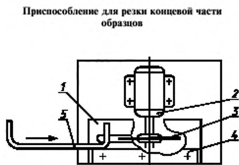
1 — стол; 2 — электродвигатель мощностью 300 Вт; 3 — отрезной диск на специальной бакелитовой основе (электрокорунд белый); 4 — упор; 5 — образец проволоки
