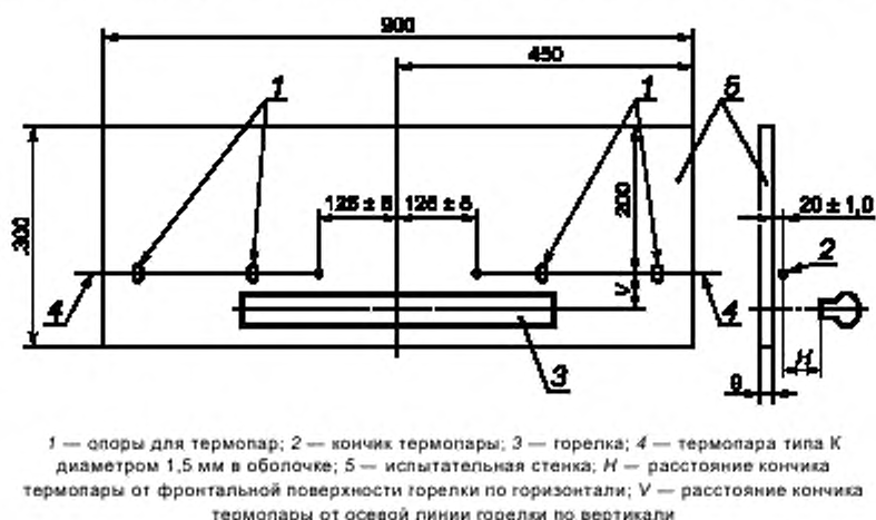
Рисунок А.1 — Расположение системы измерения температуры
