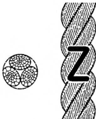
Рисунок 1— Конфигурация 3-рядного крученого каната (тип А)
