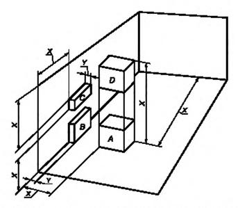
А — оборудование вдали от стены; В — оборудование, монтируемое вблизи пола или потолка и на стене или в стене; С — оборудование, монтируемое на стене или в стене; D — оборудование, подвешенное к потолку или закрепленяюе на нем или вмонтированное в потолок, X — минимальное расстояние от соседних поверхностей помещения, равное 1,5 м, если иное не установлено изготовителем; Y — рекомендованное изготовителем минимальное выступание оборудования в помещение.
