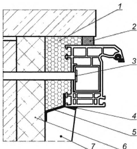
1 — минеральный утеплитель, 2 — изоляционная саморасширяющаяся паропроницаемая лента (ПСУЛ); 3 — рамный дюбель; 4 — герметик; 5 — пароизоляционная лента; 6 — компенсатор монтажного зазора (рекомендуется для утепления откоса в зданиях старой постройки, может применяться для утепления откоса и изоляции минерального утеплителя от плоскости возможной конденсации); 7 — штукатурный слой внутреннего откоса (с фаской для слоя герметика)
