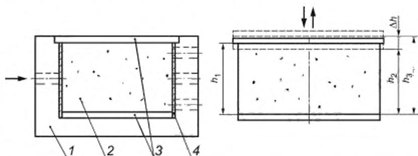
1 — корпус устройства; 2 — образец материала; 3 — алюминиевые пластины толщиной не менее 2,0 мм; 4 — смазка;  $h_1$  — положение пластин при заданной (начальной) толщине образца;  $h_2$  — положение пластин при наибольшем сжатии образца;  $h_3$  — положение пластин при наибольшем растяжении образца
