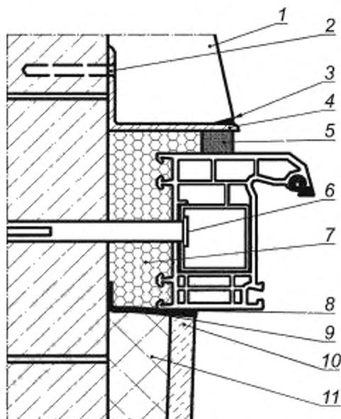
1 — штукатурный слой наружного откоса (с фаской для слоя герметика), 2 — строительный шуруп; 3 — герметик; 4 — фальшчетверть из уголка, 5 — изоляционная саморасширяющаяся паропроницаемая лента (ПСУЛ), 6 — рамный дюбель; 7 — минеральный утеплитель; 8 — герметик; 9 — пароизоляционная лента, 10 — элемент отделки внутреннего откоса, 11 — полость между неутепленной однослойной стеной и элементом отделки откоса (рекомендуется заполнять теплоизоляционным материалом)
