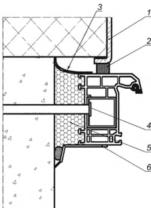
1 — элемент отделки наружного оконного откоса
