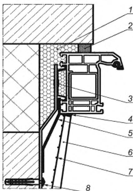
1 – пенный утеплитель, 2 – изоляционная саморасширяющаяся паропроницаемая лента (ПСУЛ); 3 – гибкая анкерная пластина; 4 – герметик; 5 – пароизоляционная лента; 6 – штукатурный слой внутреннего откоса (с фаской для слоя герметика); 7 – армирующая сетка, 8 – дюбель со стопорным шурупом
