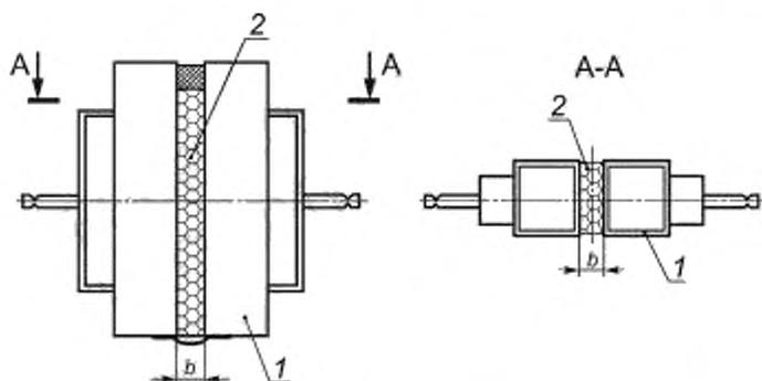
$b$  — толщина шва, 1 — обойма из алюминия или нержавеющей стали толщиной 3 мм;
