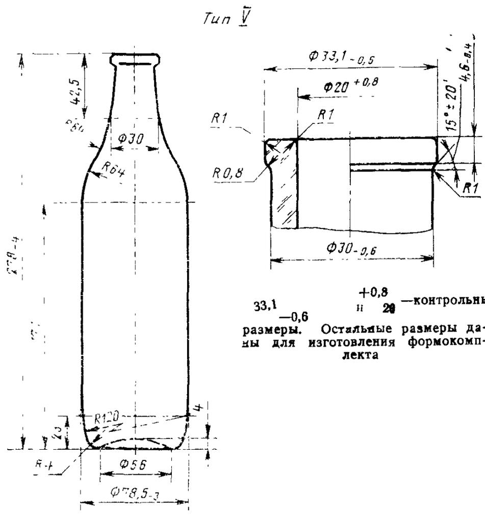
33,1<sup>+0,8</sup><sub>-0,6</sub> и 20 — контрольные размеры. Остальные размеры даны для изготовления формокомплекта
