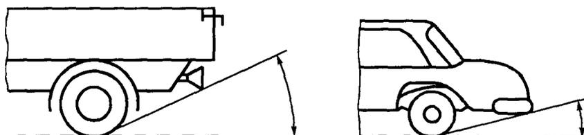
3.3 Под «продольным клиренсом» подразумевают минимальный острый угол между двумя плоскостями, которые расположены перпендикулярно к медианной продольной плоскости транспортного средства, проходят по касательной к шинам передних и задних колес при статической нагрузке и пересечение которых происходит в нижней части транспортного средства вне его колес. Этот угол определяет наибольший перекат, который может быть преодолен транспортным средством.
