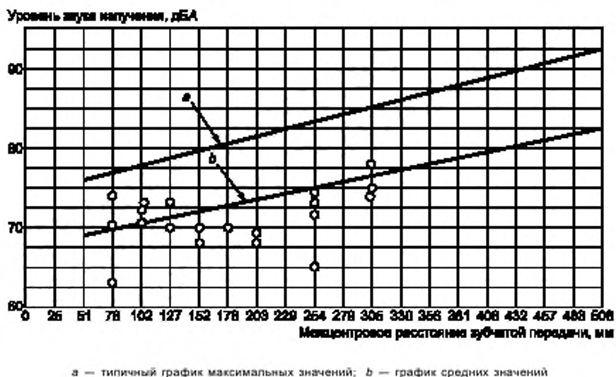
Рисунок В.7 — Уровень звука излучения одноступенчатого червячного редуктора с охлаждающим вентилятором при частоте вращения входного вала 1750 об/мин на расстоянии 1,5 м от корпуса на холостом ходу или при малой нагрузке в зависимости от межцентрового расстояния
