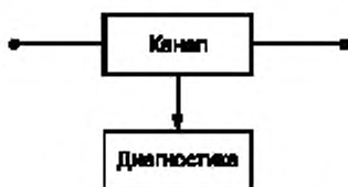
Рисунок В.3 — Структурная схема архитектуры 1oo1
