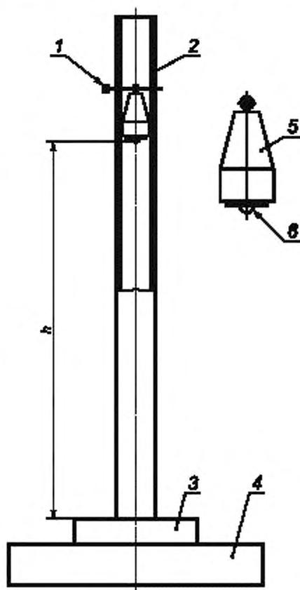
1 — регулировочный штифт; 2 — пластмассовая направляющая труба; 3 — испытуемый образец; 4 — стальная основа (масса > 20 кг); 5 — стальной груз массой 1 кг; 6 — ударная головка диаметром 25 мм из закаленной стали;  $h$  — высота падения
