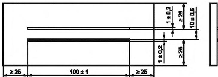
Рисунок 5 — Испытуемый образец с электродами из проводящей краски
