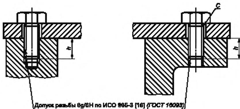
Рисунок 1 — Допуски и зазор для резьбовых крепежных деталей
