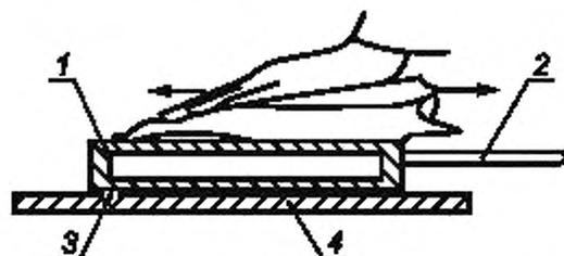
1 — поверхность А; 2 — тефлоновая ручка; 3 — поверхность В; 4 — фторопласт
