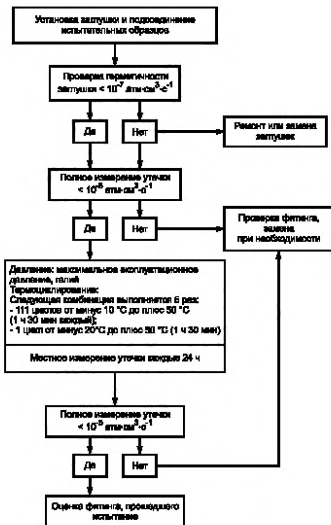
Рисунок И.1 — Испытание фитинга на герметичность
