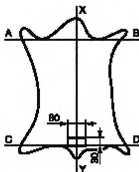
Рисунок 3 — Схема расположения образцов для определения светостойкости окраски
