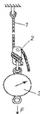
1 — канат; 2 — тормозное устройство; 3 — динамометр
