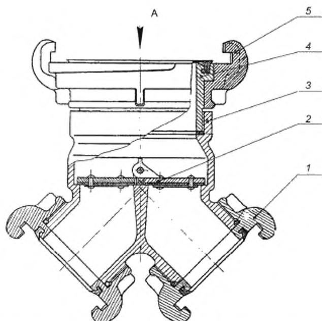
1, 5 — соединительные головки; 2 — затворное устройство; 3 — корпус; 4 — выходной патрубок
