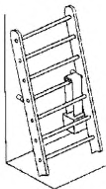
Рисунок 6 — Схема установки или подвески контрольного груза
