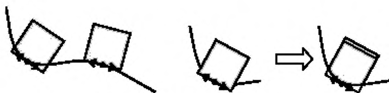
Рисунок С.2 — Метод тангенциальной грани
