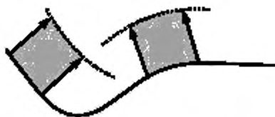
Рисунок 10 — Поверхности усредняющего объема и их ориентация относительно поверхности манекена
