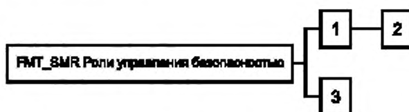
Рисунок 50 — Ранжирование компонентов семейства FMT_SMR
