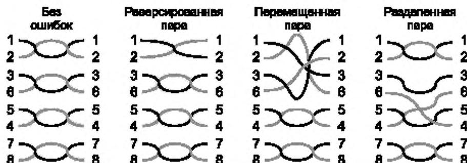
Рисунок 3 — Возможные ошибки в схеме разводки
